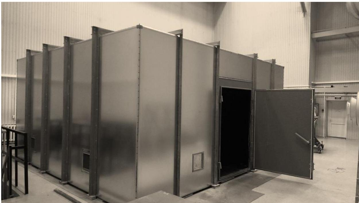
Экранированная камера ТА АС36-3
