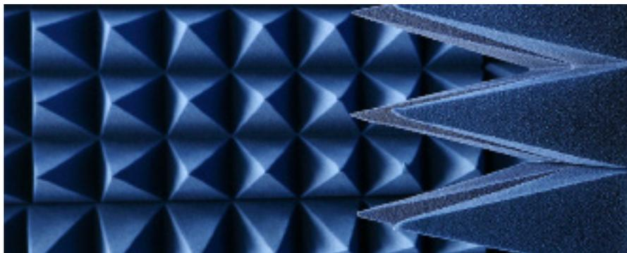
Радиопоглощающий материал предназначен для применения при создании полностью или частично безэховых камер, испытательных зон и подвижных панелей для обеспечения измерения параметров различных устройств в определенном диапазоне частот
